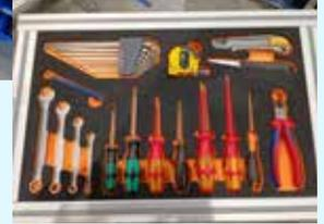
**Bewährte Hilfsmittel aus dem Lean-Baukasten wie mobile Transport- und Montageeinrichtungen, Kanbanregale oder Shadowboards erleichtern nun die Arbeit.**
